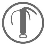
Wenn dieses Symbol während der Montagearbeiten erscheint, müssen die Teile vor dem Einbau geschmiert werden. Schmieren Sie betroffene Teile mit Universalfett.
