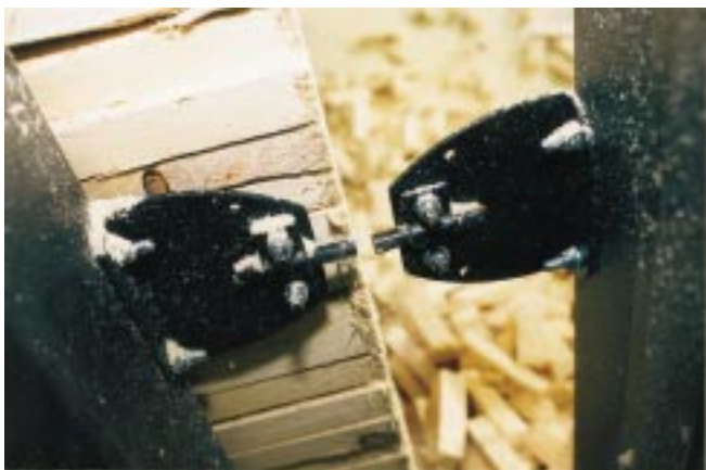
Когда торцевание сторон пакета закончено, дальнейшие замеры делаются от отторцованных сторон.
