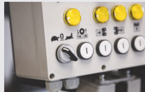
Tvåfartsmotor på matningen med vred för att enkelt reglera hastigheten mellan 3 m/min och 6 m/min..
