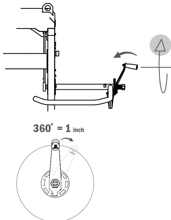
Le mécanisme de verrouillage de la manivelle comporte huit pas par tour. Chaque pas permet de déplacer la tête de sciage de 1/8" (3,17 cm), et un tour complet représente 1" (2,54 cm). Un disque 16 pas est disponible comme accessoire.
