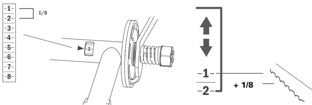
Sur l'axe de la manivelle, il y a une ouverture où vous pouvez voir les chiffres d'une graduation. Cette graduation comporte huit pas de 1/8" chacun. **CONSEIL :** Lorsqu'une planche est coupée au-dessus de la lame, il vous faut compenser le trait de scie, qui est de 1/8". Le morceau de bois sous la lame n'a jamais besoin de compensation du trait de scie. Il a la même dimension qu'indiqué sur l'échelle absolue située sur le pied avant du chariot.
