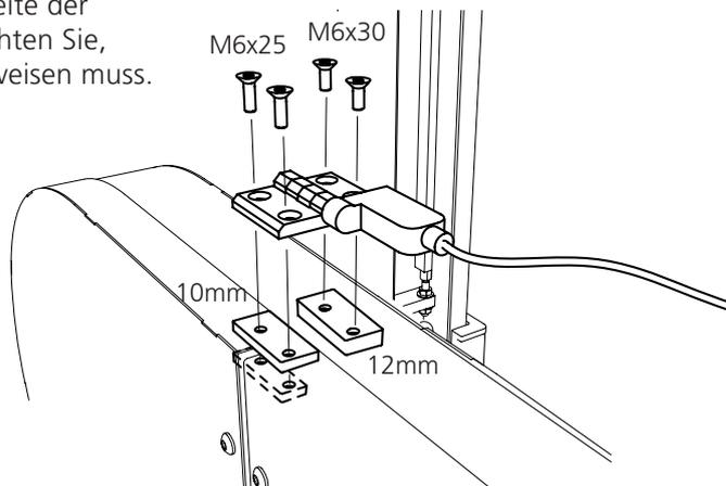
**13** Schließen Sie nun den Sicherheitsschalter entsprechend der Zeichnung am Motor an.
