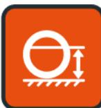
La touche GOTO a une fonction spécifique : elle permet d'exécuter la commande "aller à la hauteur X de la table de sciage". Pour utiliser cette commande, il suffit d'entrer la valeur souhaitée à l'aide du clavier numérique, puis d'appuyer sur la touche GOTO. La tête de scie se déplacera ensuite automatiquement vers la position spécifiée.
