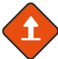
Le bouton "Bump up" a deux fonctions principales. Tout d'abord, il permet un mouvement vers le haut de la tête de scie dans les limites fixées par l'interrupteur de fin de course supérieur "virtuel" (F 88). Cette fonction permet d'éviter les dommages accidentels à l'équipement de la scierie et garantit un fonctionnement sûr.
