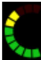
Il s'agit de la valeur limite du moteur principal. En cas de fonctionnement prolongé du moteur principal dans ce mode, le moteur risque de surchauffer et, par conséquent, de perdre sa durée de vie.
