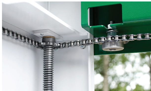
Kedjetransmissionen skall gå lätt! På bilden syns även kedjespännaren.
