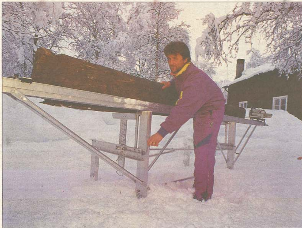
– Utan Solosågen hade vi inte kunnat renovera Stockstugan. Vi använde stockar från gamla logar för att få den rätta känslan. Det finns inte ett sågverk som tar på sig att såga kruttorra gamla furor, säger Stig Strand.
