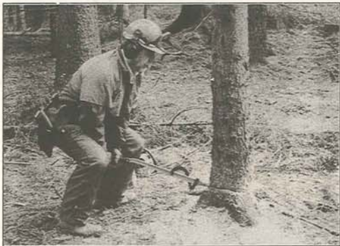
Tippa omklull trädet genom att sticka in ett brytjärn. Lyft med benen, inte med ryggen.
