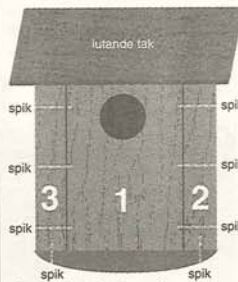
Använd galvade spikar eller skruvar. Se till att de inte sticker ut på insidan och skadar fåglarna.
