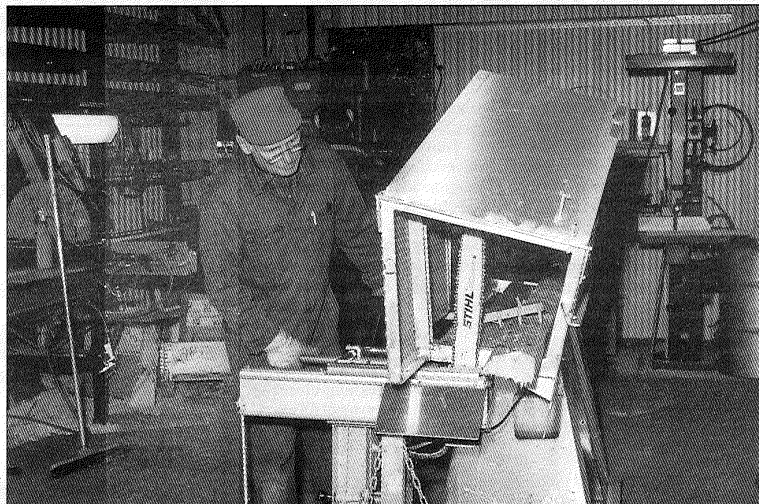
Nisse Söderholm visar ett exemplar från Logosols uppfinnarverkstad. Det är en vedkap som drivs med Logosols elsåg. Du som redan har elsåg får en säker och effektiv kap för mätliga pengar.
