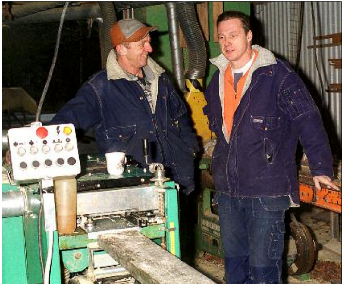
Thomas Petersson och svärsonen Mats Kruse vid en av Kallinge Plåt & Byggnadsmaterials två fyrkutteriga Logosol-hyvlar. Med två hyvelmaskiner kan de jobba parallellt och hyvla fler sorters lister snabbare.
