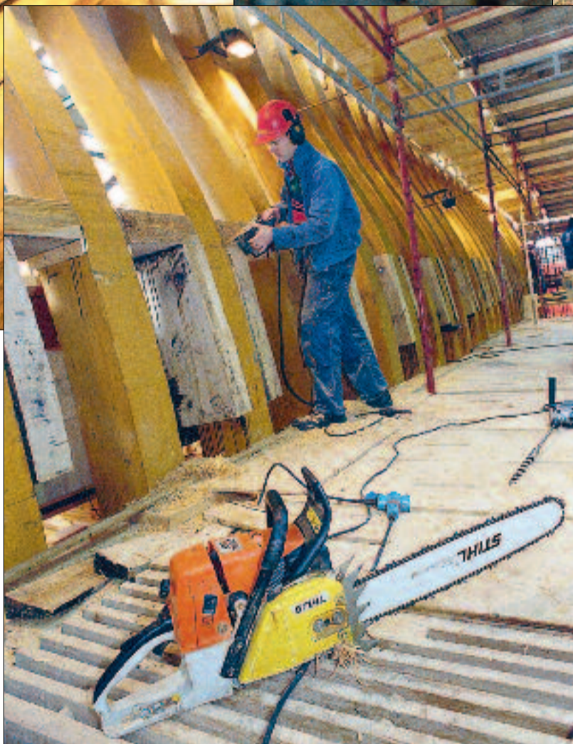
Varvet bygger det mesta till fartyget med gamla metoder. Undantagen är motorsågar, handverktyg och Logsols elsågar. Bilden ovan visar hur fartyget ska se ut när hon är färdig att segla till Kina år 2004.
