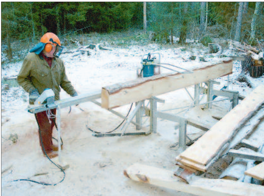
Börje och Tage Söderholm har den senaste och modernaste Solosågen på Runmarö med elsåg, automatisk matning, saxlyftare och stockrullar.
