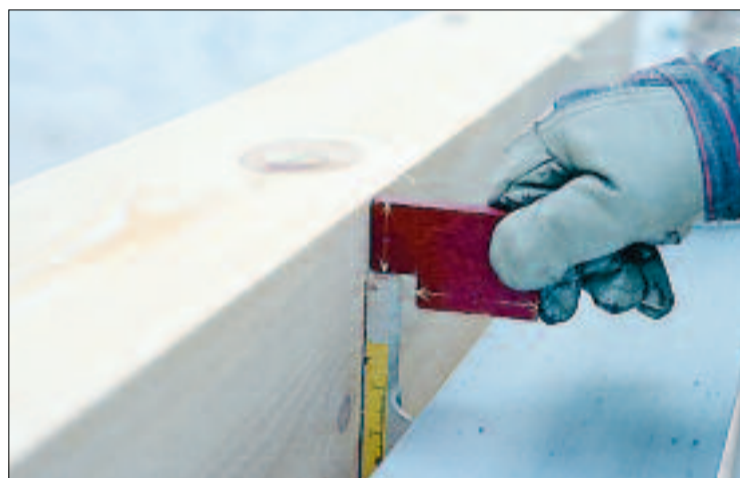
Passbitar är ett enkelt sätt att kontrollera att virket håller rätt mått före sågning.
