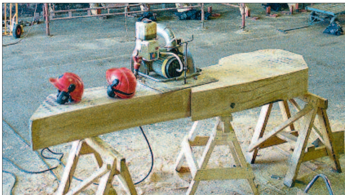
Logosol E5000 ombyggd till sticksåg svarar för det mesta av utsågningen av spant och komponenter till segelfartyget. Djungelsågen används för att såga de största stockarna i skogen.
