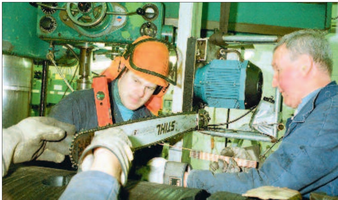
Roger Edman använder normalt sågverket för att tillverka bordsskivor. Nu blev han oväntat inkallad för att såga tjocka gummicylindrar, ett jobb som han klarade bättre än andra som försökt med laser, betongsåg, vattenjet och andra metoder.
