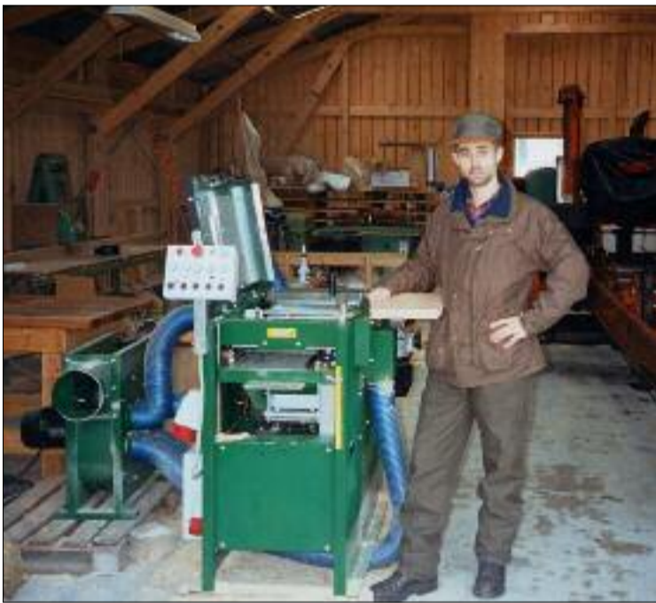
Christian Svendsen, indehaver af Kjellerup Mobilsavværk, ved sin PH260 fra Logosol. Den første opgave for Christians høvl, blev fremstilling af et gedigent gulv af Douglas gran. Plankerne blev høvlet til i en arbejdsgang med not og fer. Dimensionen på de færdige planker er 32 x 247 mm. Der er foreløbig savet 25 kubikmeter douglas ud, og størsteparten er anvendt til gulvplanker.
