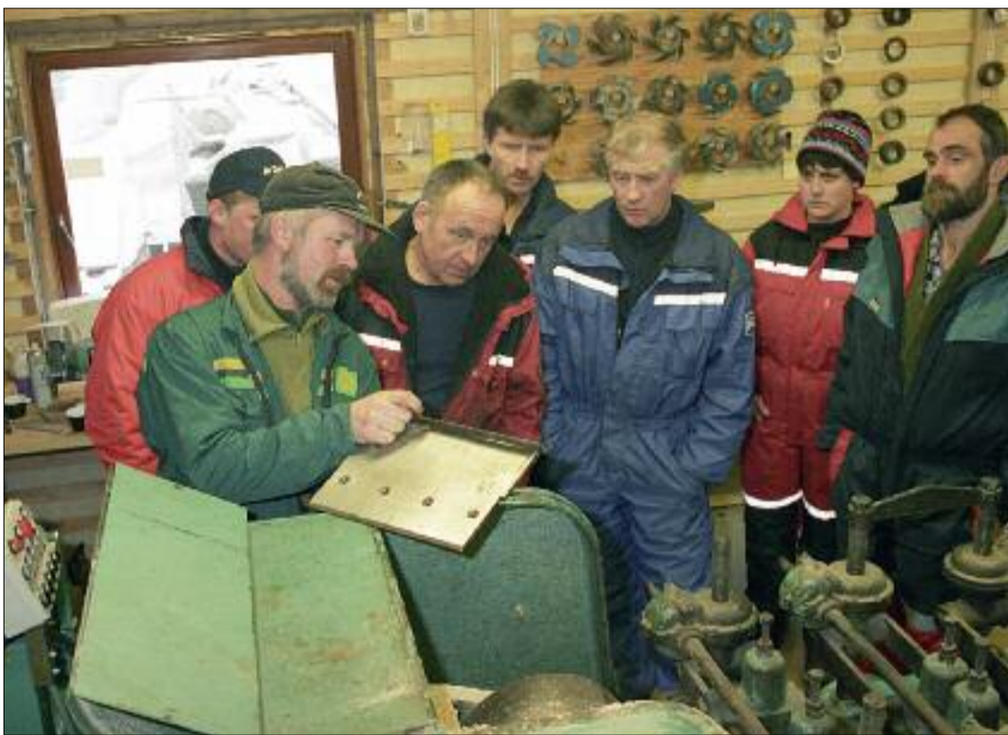
Skolans industrihyvel väger sex ton, har sex kuttrar och hyvlar över 100 meter list i minuten. Ändå föredrar eleverna Logosols PH 260, som används parallellt under utbildningen.
