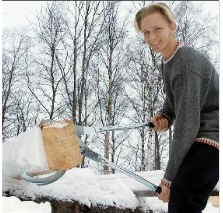
Konstruktören Mattias Byström visar hur den patenterade stocklyftaren fungerar. Ena griparmen hindrar stocken från att rulla tillbaks, medan den andra vänder stocken åt rätt håll.
