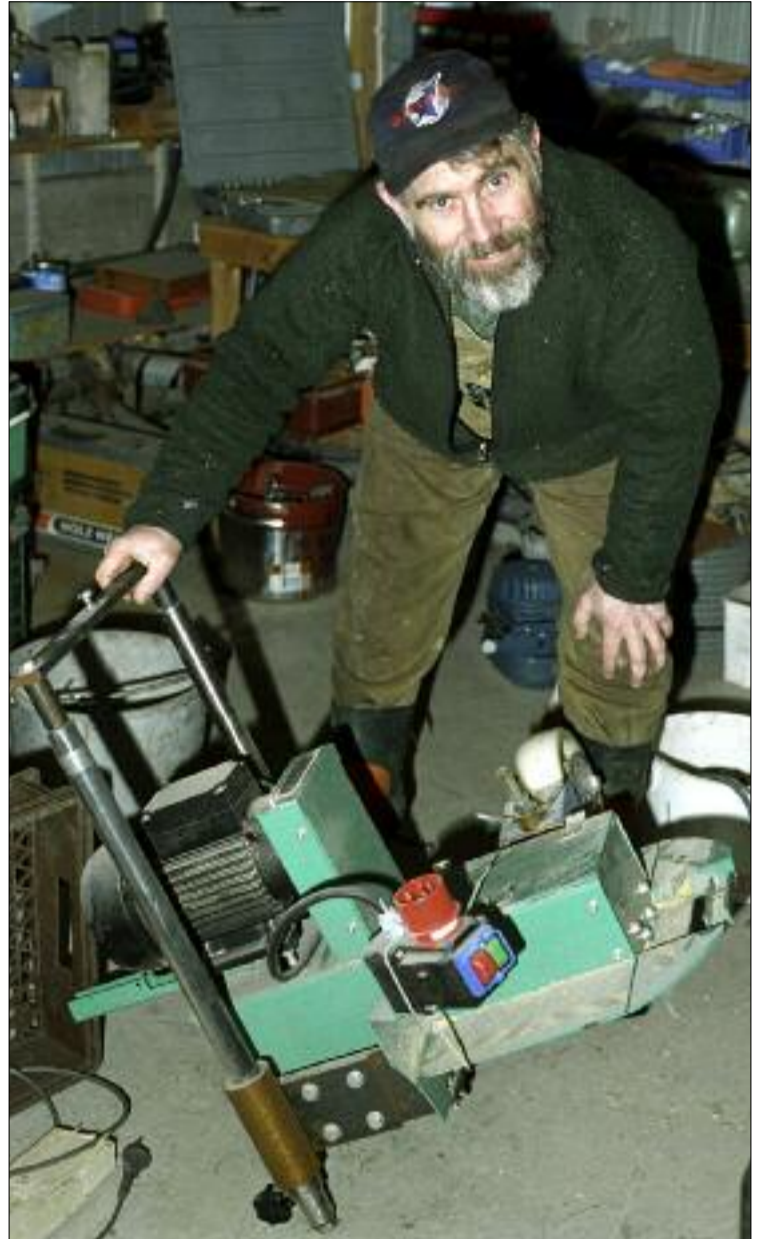
Med en enkel ombyggnad passar Logosols timmerfräs på en cirkelsåg. Roger Fagerberg har dessutom konstruerat ett hydraulsystem för styrning av fräsen.
