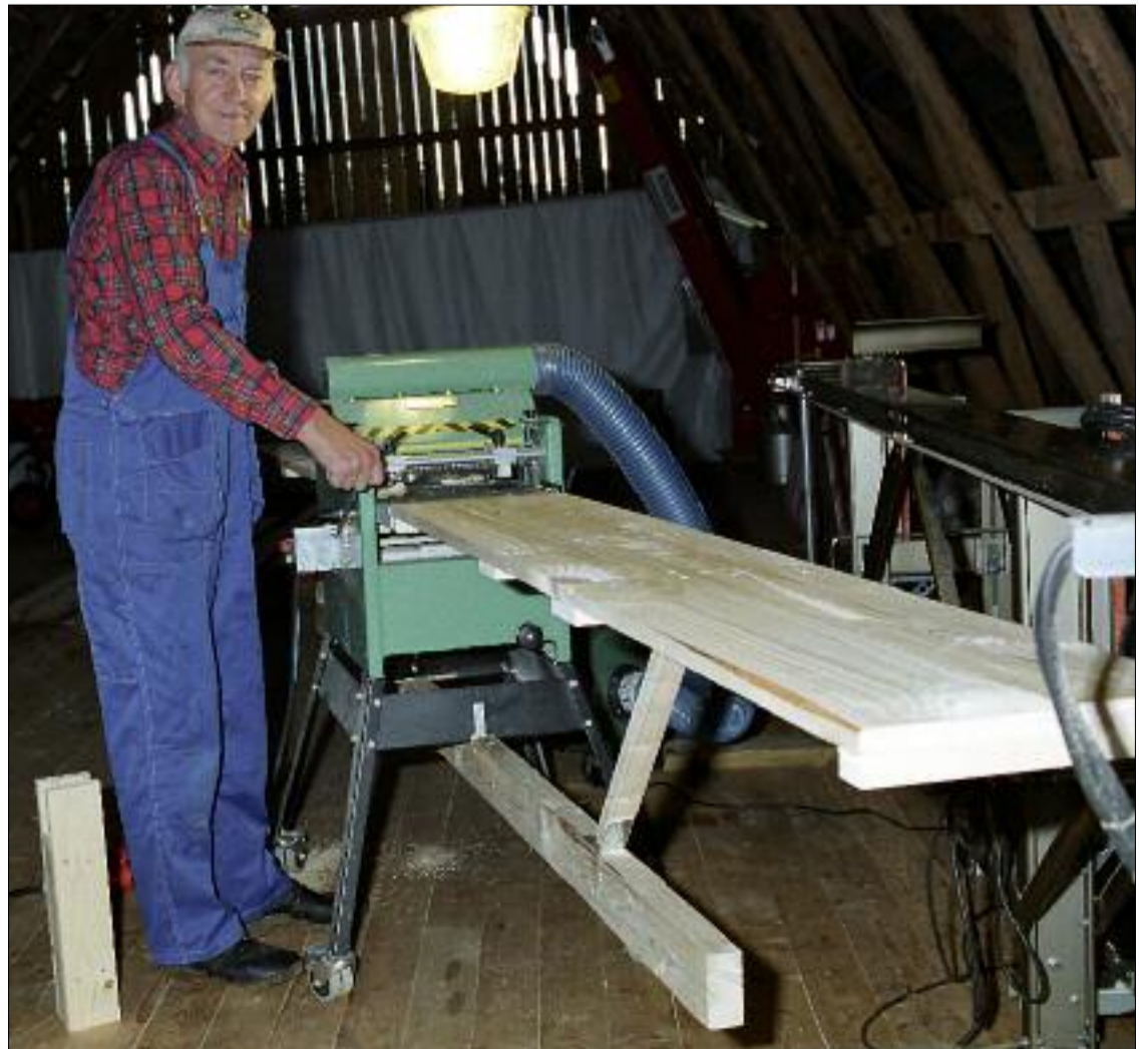
Börje Nilsson hittade en punkt att förbättra på Solohyveln: In- och utmatningsbordet. Han konstruerade ett eget och resultatet blev en listig konstruktion som följer med när hyveln ställs in.
