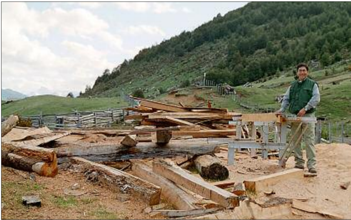
Solosågen öppnar nya möjligheter i den nybefolkade, södra delen av Chile. Här finns gott om skog, men det är långt mellan eluttagen. Solosågen och den bensindrivna timmerfräsen löser problemet.
