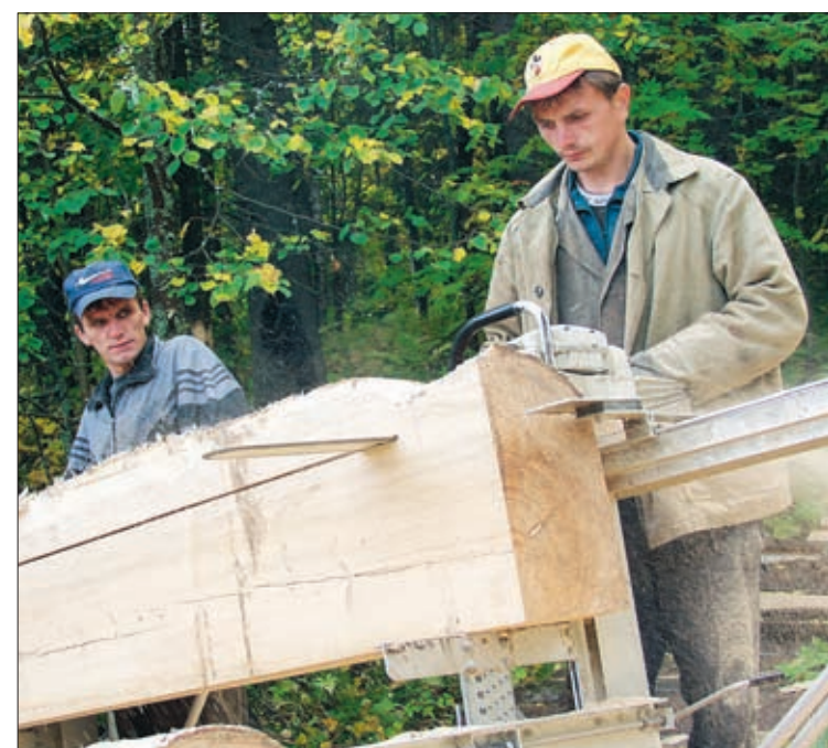
Det är billigare att transportera färdiga slipers än stockar. Därför sker tillverkningen delvis på avverkningsplatserna.
