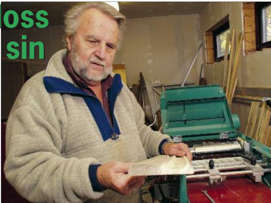
Ivan Lund skickade in en bit av en list till Logosol och beställde ett specialstål som hyvlar fram hela den grova och utsirade golvsockeln på en gång. Själva stålet syns på bilden nedan.
