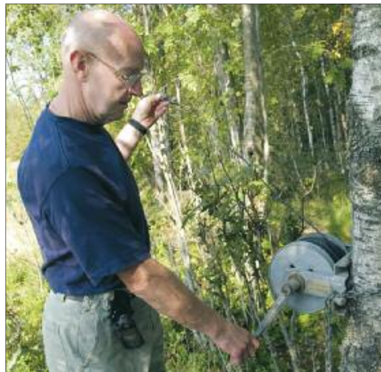
Sviterna efter en bilolycka gör att Bert måste ta till olika knep för att underlätta arbetet. Vid huggning drar han ned trädet med det här spelet, vilket också ökar säkerheten.
