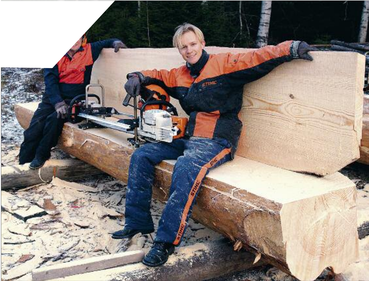
Alla träd går att såga med Big Mill System, oavsett hur stora de är. Hemligheten är att kombinera rätt delar ur byggsystemet till det optimala sågverket. Här har Berra Bergström, Bengt-Olov Byström och Mattias Byström sönderdelat en tall med en rot diameter om 85 cm, ett praktexemplat huggen i Skuleskogen vid Höga kusten,
