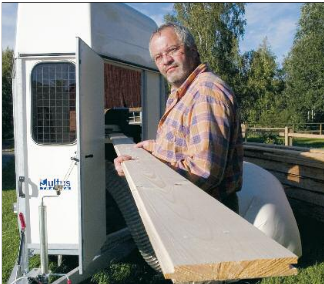
Hästvagnen är som en trollerilåda. På ena hållet stoppar Helmut Fuchs in en råsågad bräda. På andra hållet kommer den ut fyrsidigt hyvlat. Hemliugheten är en Logosol PH260 som står fastspänd i vagnen med spånsug och allt.
