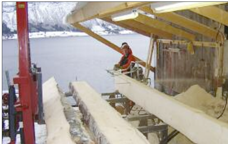
– Så langt har jeg sagt og dimensjonert materialer til bruk ved bygging av nytt tak på låven, ca. 270 m 2 , sier Øystein Espelund.
