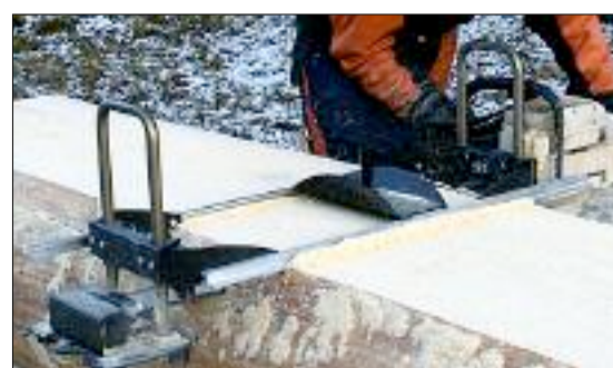
Big Mill LSG för grov sågning med svärd upp till 150 cm. Max stockdiameter 135 cm.
