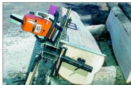
Big Mill Basic kommer med 2,75 m linjal och smarta hållare som du bultar fast på stammen.
