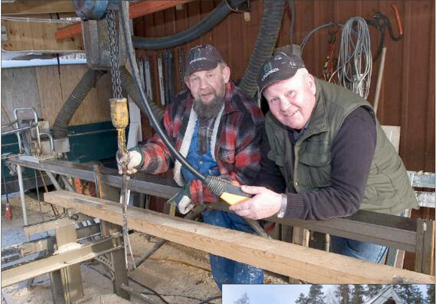
Bo Andersson och Harry Nyberg har en bra arbetsplats, med rejält stockbord, en telfer för att lyfta stockarna och spånutsug på sågaggregatet som blåser spånet direkt till en täckt vagn.
