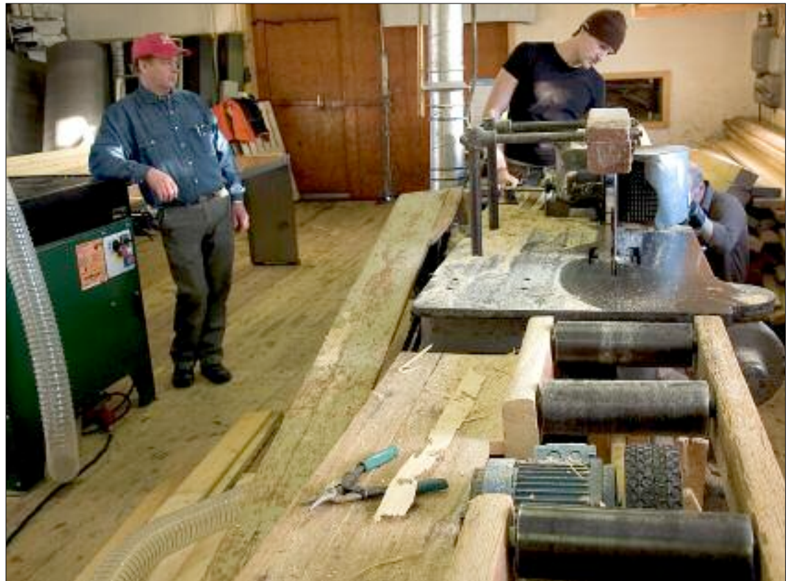
En torrkliv är en nödvändig maskin på varje hyvleri och har så varit i långliga tider. Här är en modell äldre hos hyvleriet Bondsjö Trä. Dess ägare Dick Adolfsson (t v) lutar sig mot den moderna motsvarigheten från Logosol.
