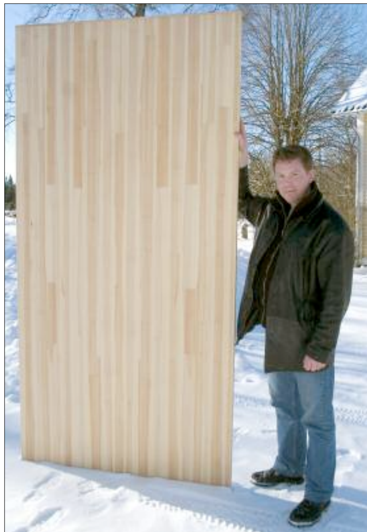
Dick Sandberg med ett forskningsresultat, en skiva av stjärnsågat virke. Nu diskuterar Logosol med honom om utveckling av nya metoder för småskaligt rötskydd av trä.
