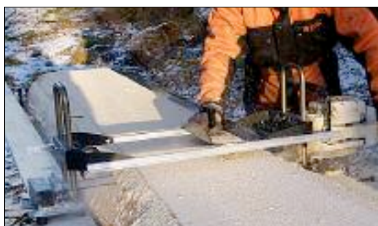
Big Mill Pro ger valfrihet att såga exakt eller riktigt grovt. Dubbla Timmerjiggar och linjaler ger snäva toleranser i sågningen.
