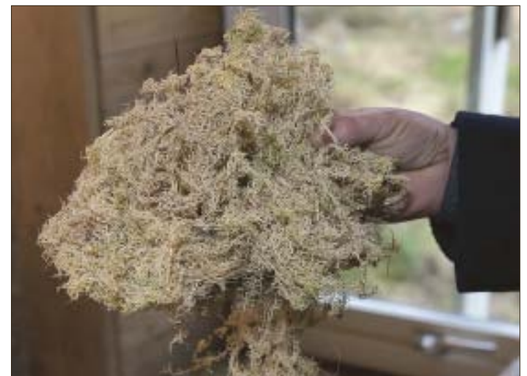
Det mesta byggmaterialet kommer från närområdet, även mossan som används som drevning runt fönstren.
