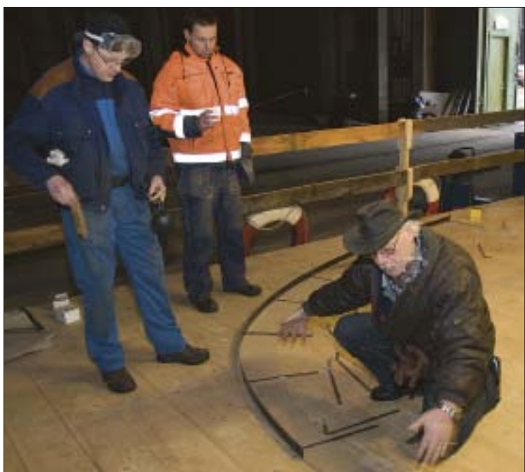
Här växer mallen fram för tillverkning av fartygets spant.
