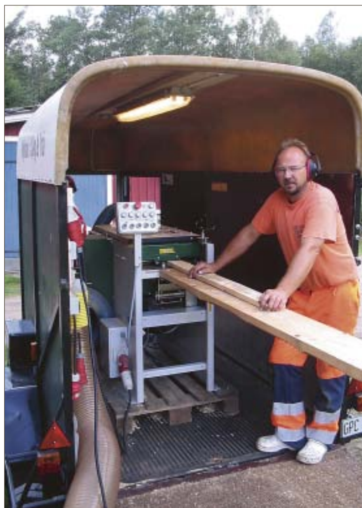
Tomas Andersson kör runt i trakterna av Laholm och hyvlar med en PH260 i ett hästsläp.
