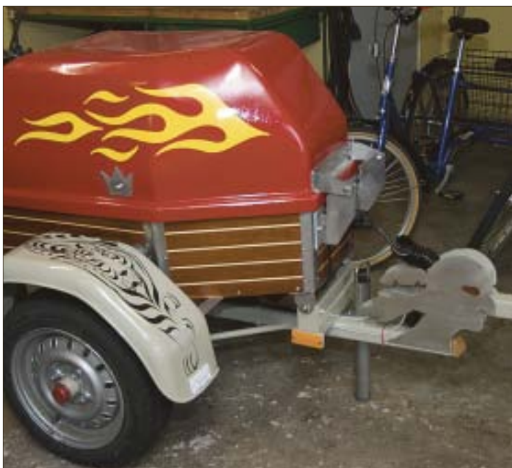
Släpkärra till motorcykel, delvis byggd av trä.
