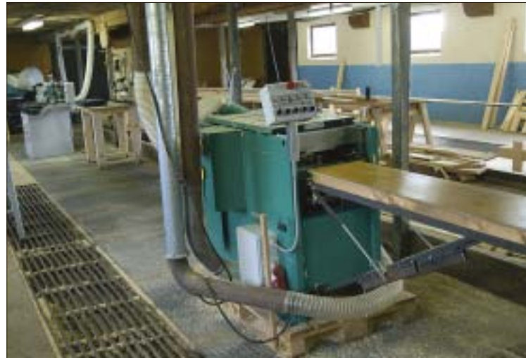
Hyvelmaskin och multifräns står bredvid utgödslingen, som tar spånet som utsuget missar.
