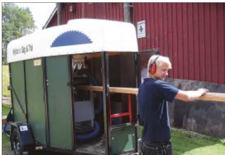
Den enda ombyggnaden som krävdes för att hästsläpet skulle bli hyvleri var en lucka i fronten.
