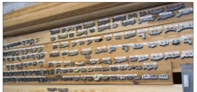
Delar av stålsortimentet för hyvleriets 170 profiler,
