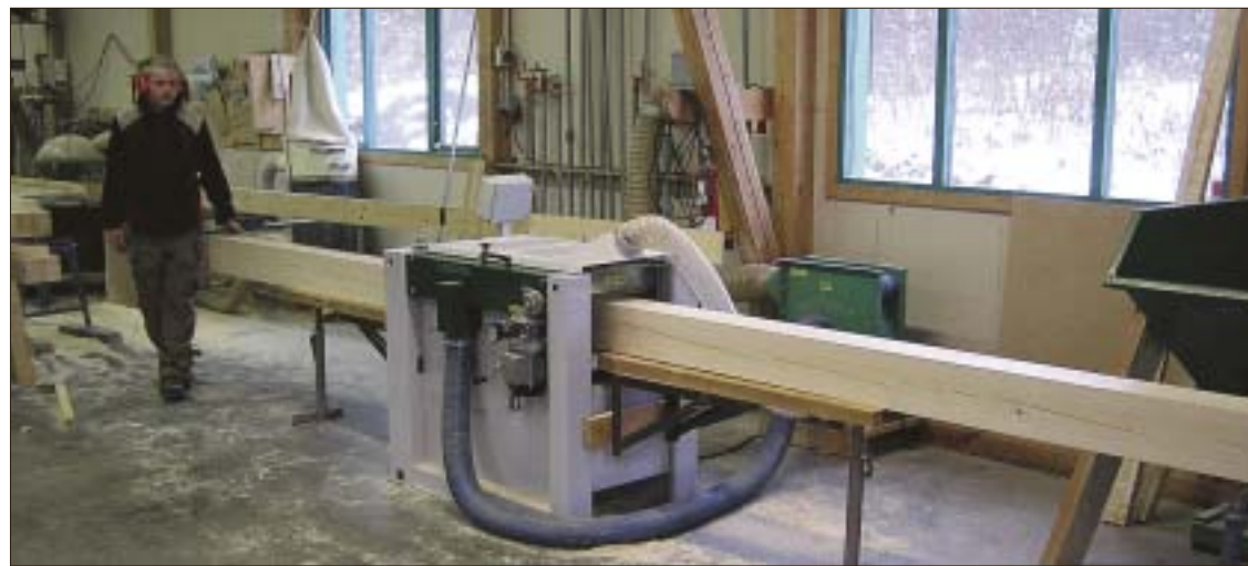
PH260 er yppelig til små serier der en sparer mye omstillingstid, høvelen er enkel å stille inn og er enkel å bruke, mener Anders Frøstrup.
