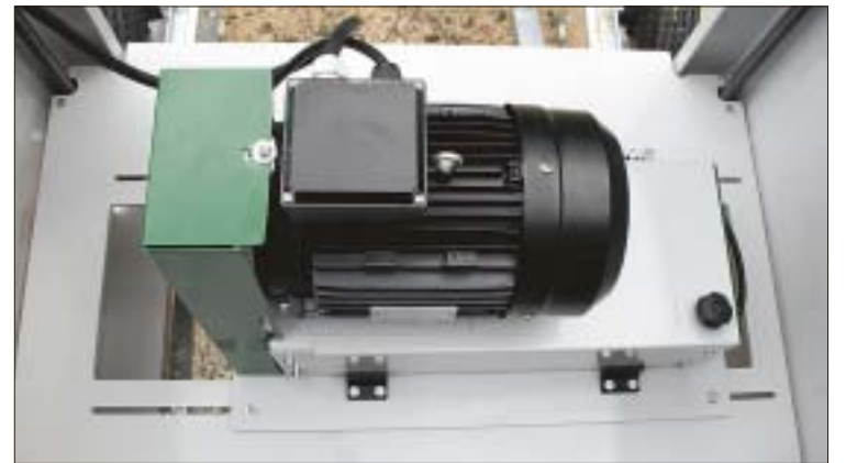
Hela motorpaketet med kutter kan förskjutas i sidled, vilket ger en hyvelbredd på 600 mm.
