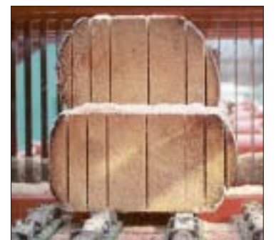
Ramen med upp till 20 sågblad gör Låksågen så snabb.
