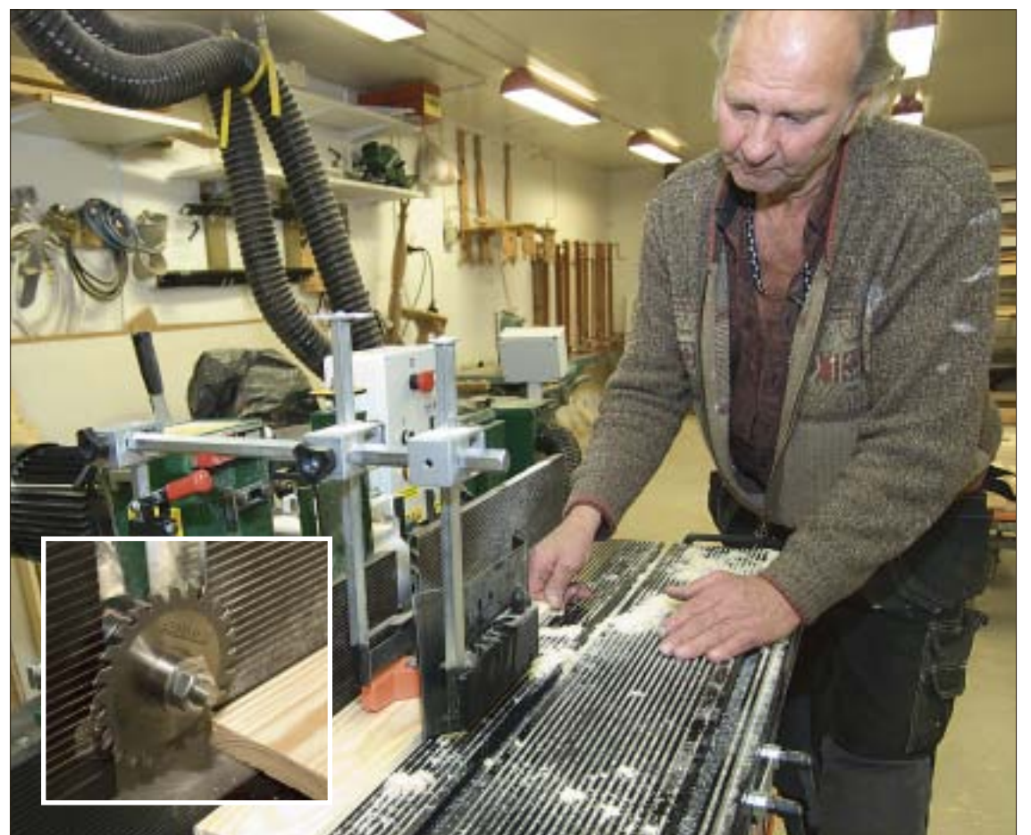
Sten-Gustav sågar fram spåret i lådsidorna med Logosols vertikalfrens MF30. Den infällda bilden visar sågklingan, Spindeln kan vridas 180 grader.
