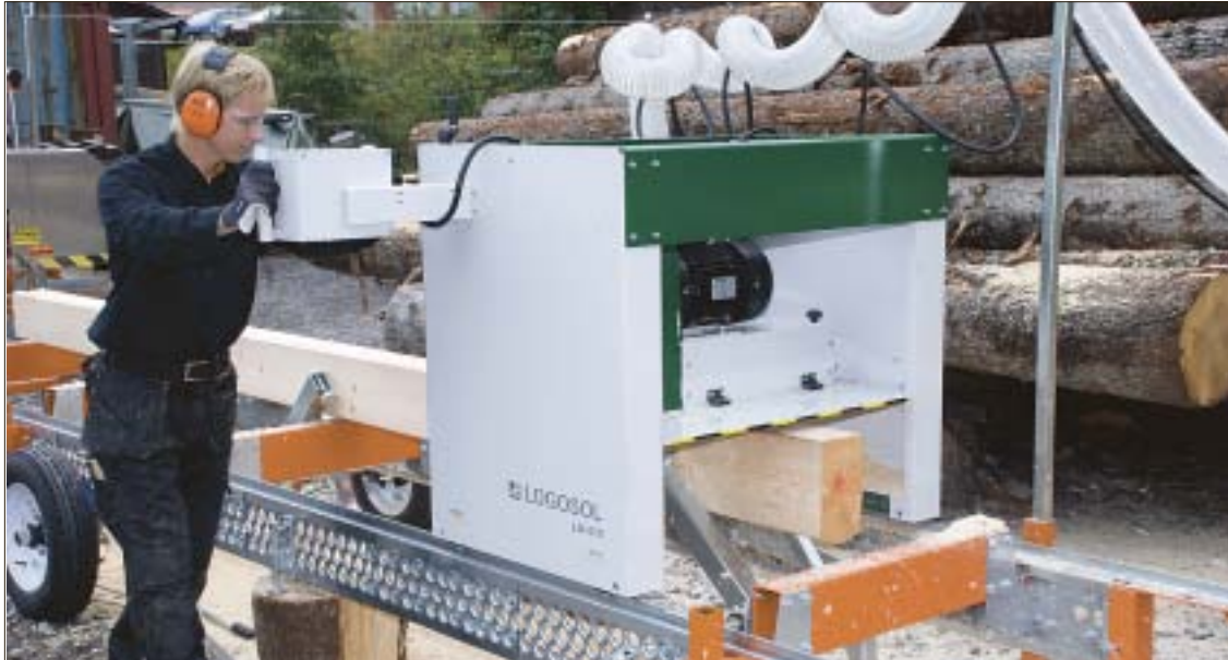
Den nya timmerfräsen till Logosols stockbandsåg är på samma gång en rikt- och planhyvel för långa balkar i dimensioner upp till 600 x 600 millimeter.
