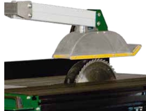
Logosols formatsåg PS 315 levereras bara med SUVA-skydd. Det kostar en slant men är det säkraste skyddet.
