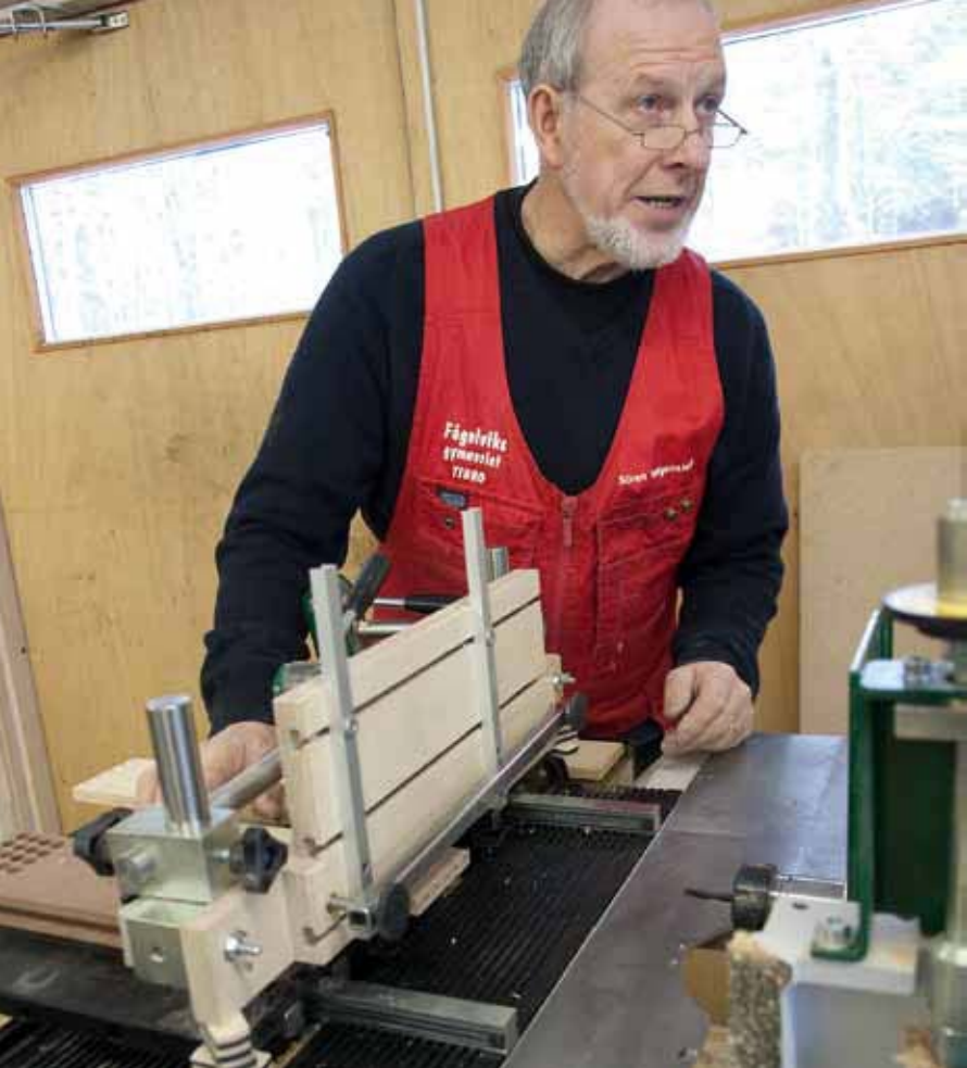
– Multifräsen kan utvecklas i det oändliga, säger Sören Wigenstedt. Här syns hans vertikalbord, som ökar nyttan av ett XY-bord, i synnerhet vid slitsning och sinkning.
