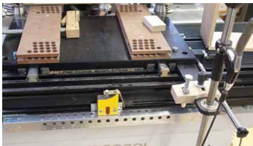
Delningsskena för XY-bord. Läsning med handbroms. (Nedan)
