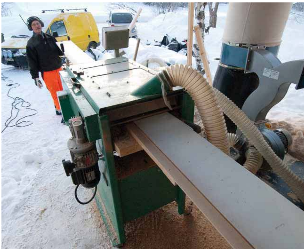
Tommie Johnsson hyvlar fönstersalning av MDF på uppdrag av ett stort hyvleri. Hittills har det blivit 4 700 löpmeter. För lite för den store, lagom för den lille.
