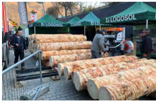
• Stockarna, som på tre dagar sågades upp med bandsågverket B751, innehöll cirka 15 kubikmeter virke.
