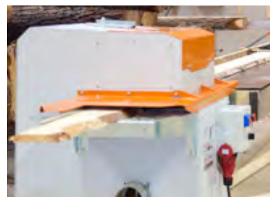
Med ett separat kantverk får sågaren en maskin som effektivt sågar bort kanterna på brädorna.
