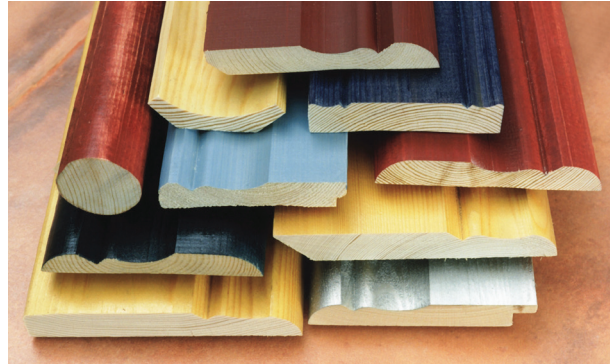
Några av de ovanstående profilerna är exempel på bearbetning där kuttern skär genom trästycket helt och hållet.
