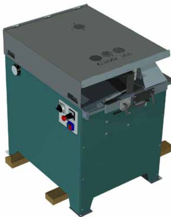
Placering av skyddande trälager under maskinen vid lyft med gaffeltruck.
