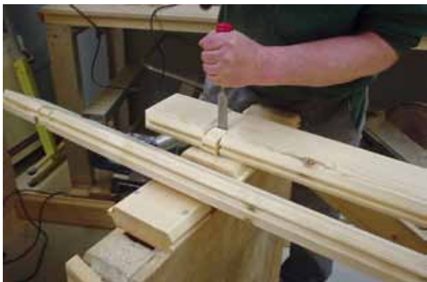
Använd ett stämjärn och slå bort klossarna mellan sågskären.
