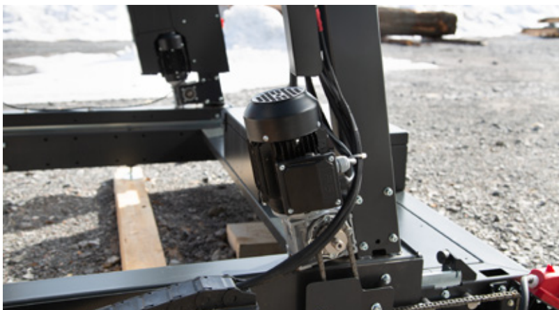
• Steglös matning med dubbla motorer ger en jämn och fin gång.
